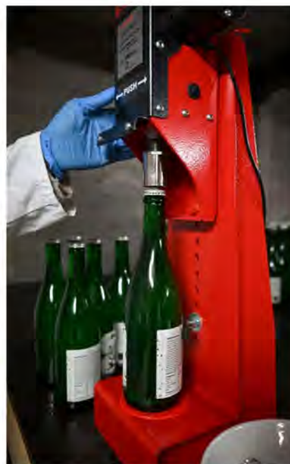
Med ett enkelt knapptryck pressas kapsylen på plats. Maskinen är av märket Ferrari.
